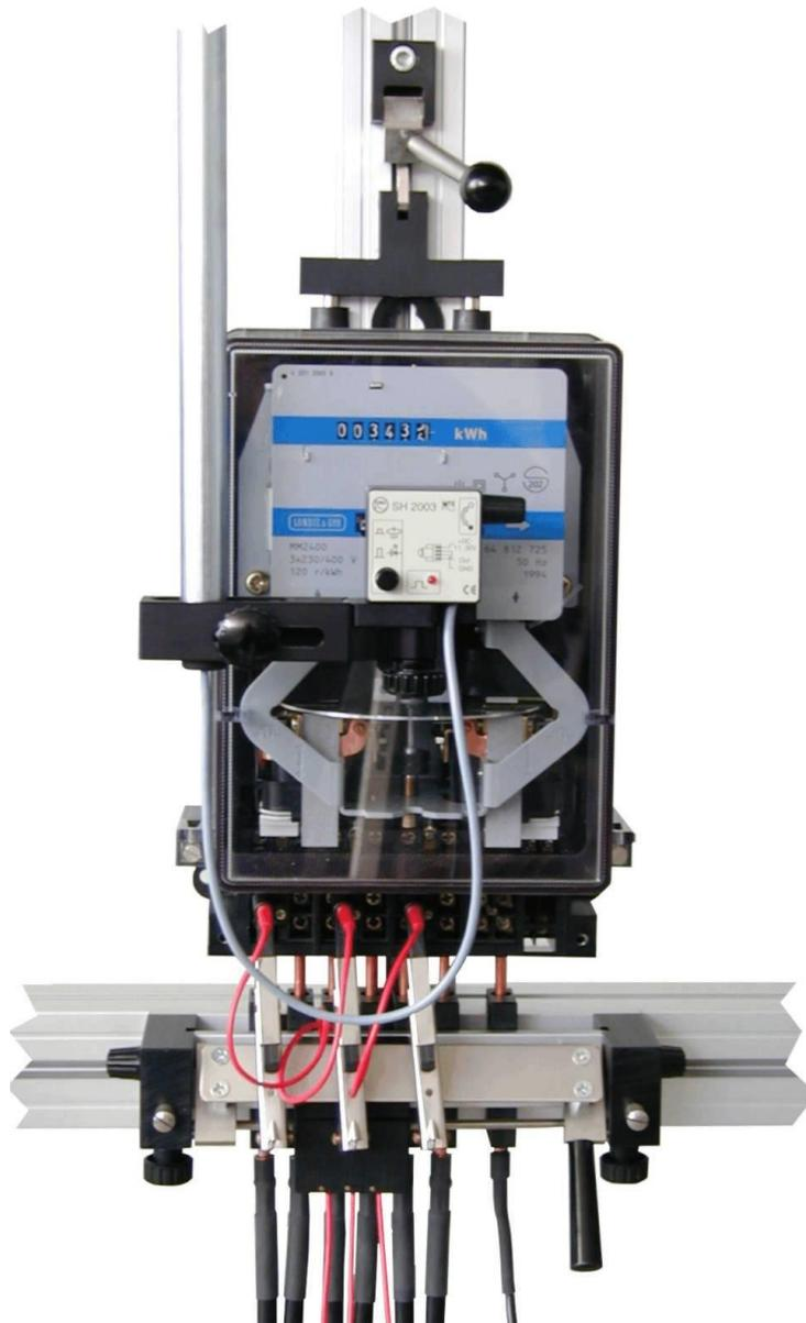
El dispositivo de conexión rápida QCD viene utilizado en equipos de ensayo de contadores, y especialmente aplicado allá donde el factor tiempo sea de gran importancia, para la calibración y verificación, a la hora de montar y contactar los contadores de electricidad.
